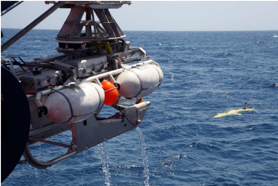
En primer plano, la plataforma de lanzamiento Caliste, una vez ha dejado el AUV AsterX en el agua (en segundo plano), a punto de empezar la inmersión. En alta resolución en:
