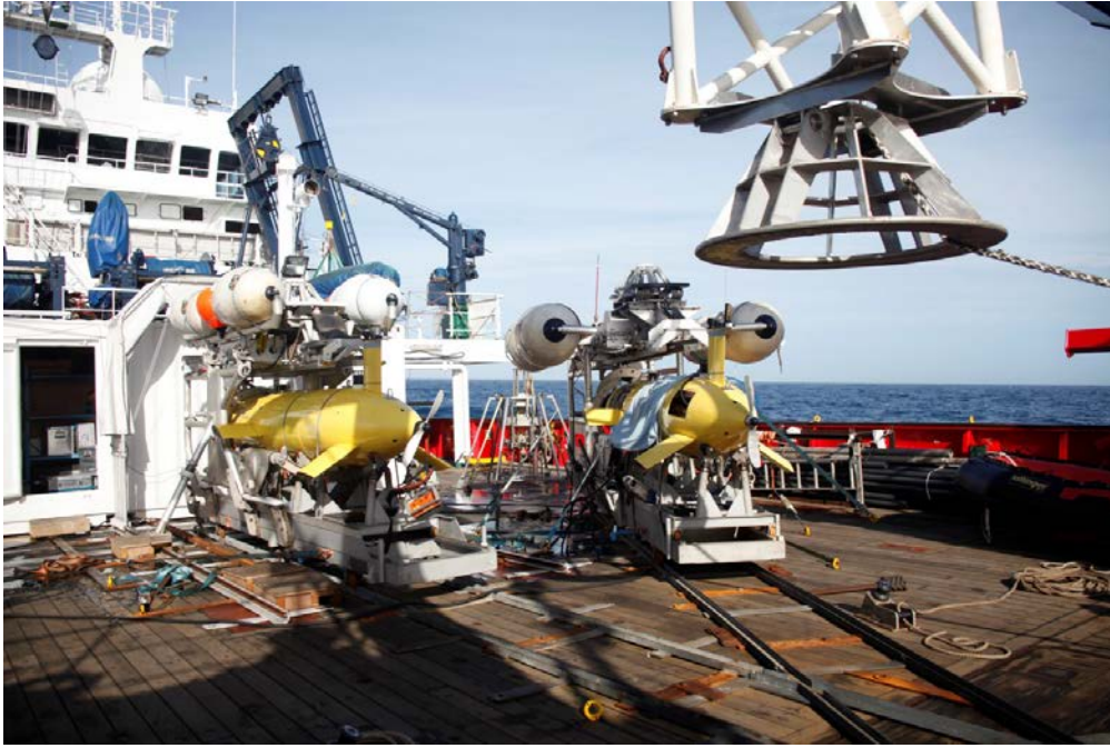
Los AUV AsterX e IdefX, con sus respectivos sistemas de lanzamiento (Caliste) en la cubierta del "Sarmiento de Gamboa". En alta resolución en:
